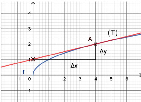
Le **nombre dérivé est la pente de la tangente (T)**. Il suffit de savoir de combien on monte ou on descend quand on se décale de  $\Delta x$ .
