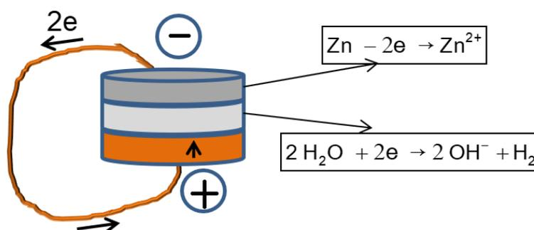
6) Une pile Volta dégage du **dihydrogène**.
